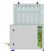
Baño para experimentos de estanquidad en embalajes alimenticios (experimento de fugas de gas).
